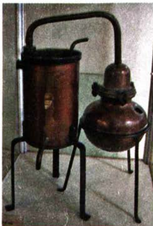
Мал. 66. Апарат для перегонки спирту (1500 р.)
