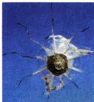
Мал. 121. Куленепробивне скло виготовляють із полімерних матеріалів
