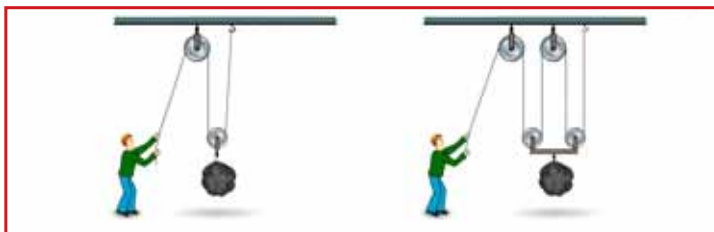
Рис. 4.31. Зазвичай на практиці використовують комбінацію рухомого і нерухомого блоків
