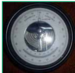
Рис. 3.66. Барометр-анероїд
