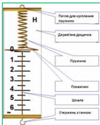
Рис. 3.26. Будова плоского лабораторного динамометра
