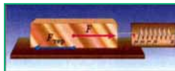
Рис. 3.39. Вимірювання сили тертя
