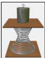
Рис. 3.4. Пружина деформується під дією сили, з якою на неї діє важок
