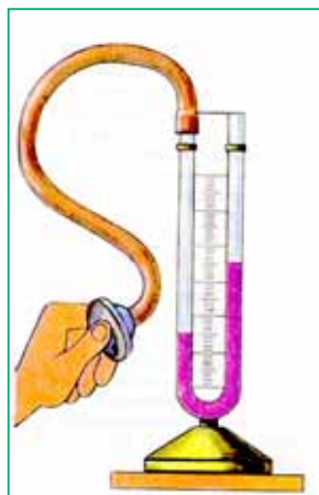
Рис. 3.72. Дія рідинного манометра
