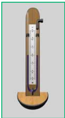
Рис. 3.71. Рідинний манометр
