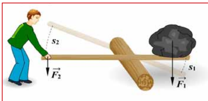
Рис. 4.34. Сили, прикладені до плечей важеля виконують роботу
