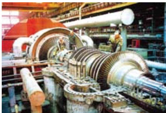
Рис. 226. Монтаж турбіни на заводі «Турбоатом» (м.Харків)
