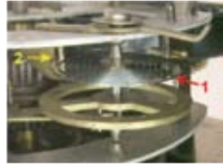
Рис. 72. Балансирний механізм: 1 — балансирна пружина, 2 — регулятор довжини пружини
