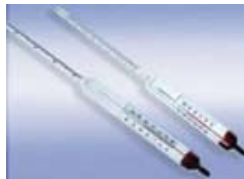
Рис. 99. Ареометр — прилад для вимірювання густин рідин
