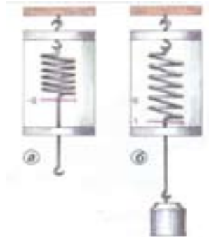
Рис. 116. Градування динамометра: а) нанесення нульової поділки ; б) нанесення поділки, яка відповідає дії сили 1 Н
