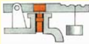
Рис. 212. Запобіжний клапан
