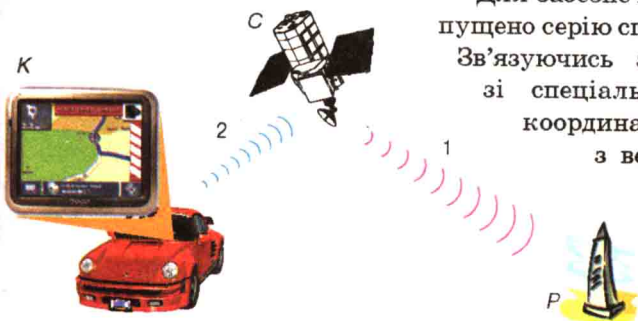
Рис. 4 — Схема роботи системи GPS. С — супутник; Р — репер; К — користувач приладу GPS. (1) — радіосигнал для зв'язку з репером; (2) — радіообмін із користувачем
