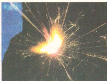
Мал. 1.65. Зварювання металу за допомогою електричної дуги
