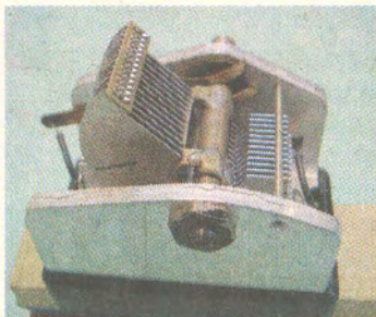
Мал. 1.35. Конденсатор змінної електроємності з повітряним діелектриком
