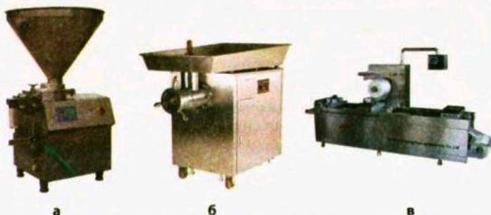
Рис. 4.5. Обладнання, яке застосовується на м'ясокомбінатах: а — вакуум-шприц для наповнення ковбас; б — промислова м'ясорубка; в — термоформовочні лінії для вакуумної упаковки м'ясних виробів
