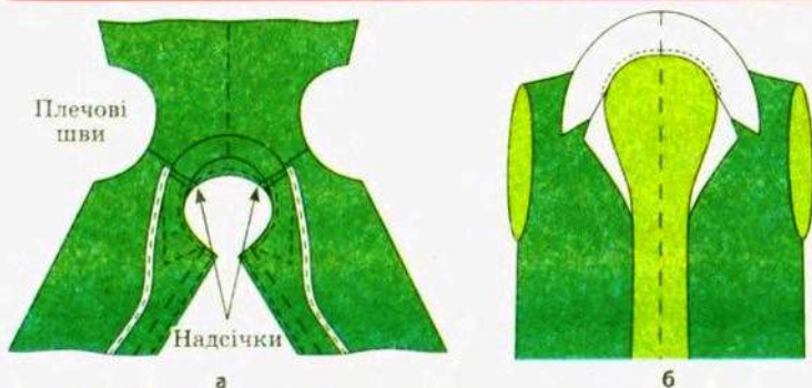
Рис. 2.18. З'єднання коміра з горловиною
