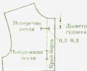
Рис. 2.28. Горизонтальні петлі заходять за лінію середини переду на 0,2—0,3 см, вертикальні петлі розташовуються на лінії середини переду
