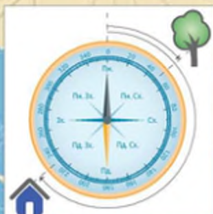
Мал. 26. Визначення азимуту за допомогою компаса
