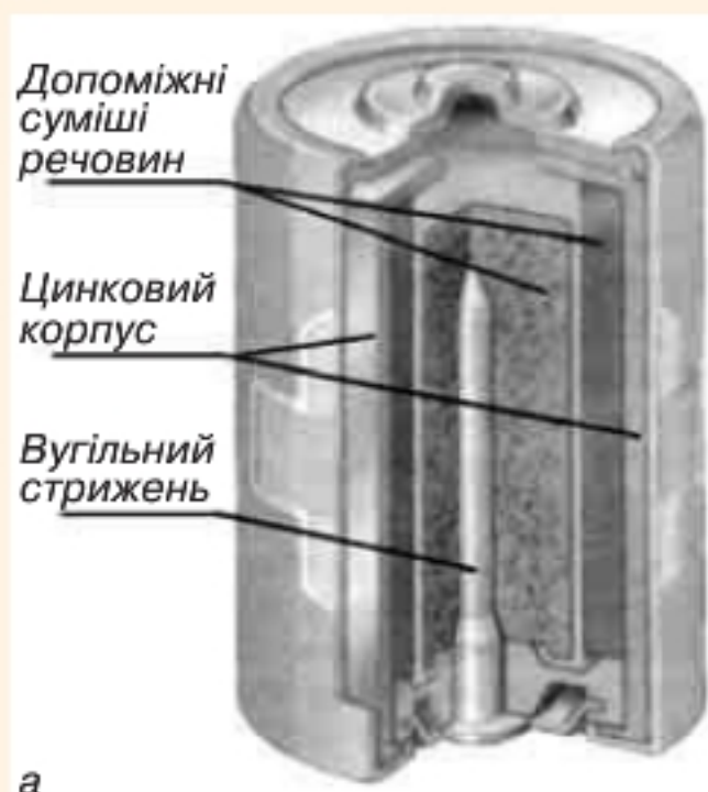
Мал. 106. Сухі гальванічні елементи: а — будова гальванічного елемента; б — гальванічні елементи і батарея
