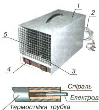
Мал. 153. Конструкція електричного обігрівача:
