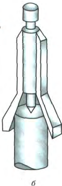
Мал. 109. Розмічання (а) та накернювання (б) центрального отвору
