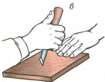
Мал. 90. Положення різака під час різання: а – «до себе»; б – «від себе»
