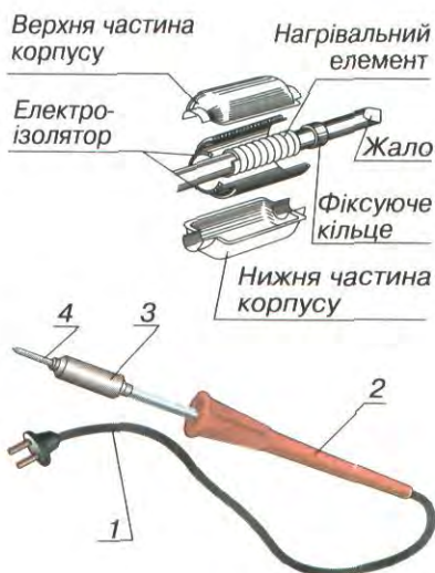
Мал. 155. Конструкція електричного паяльника:
