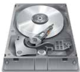
Накопичувач і жорсткий магнітний диск (вінчестер)
